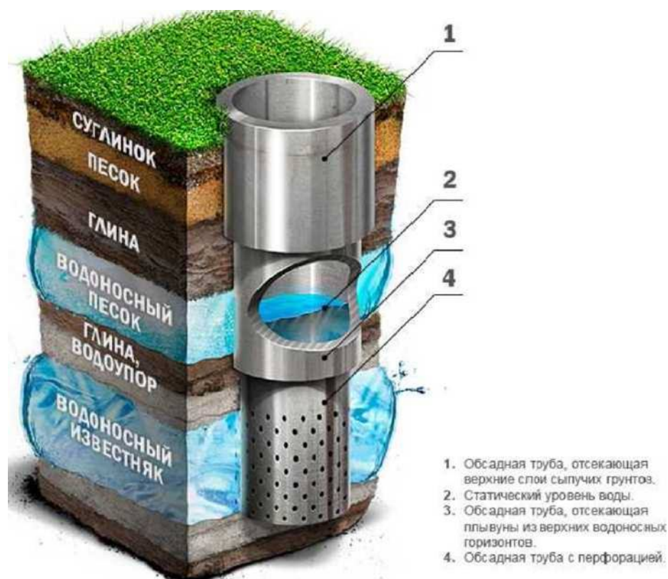
Рис. Конструкция артезианской скважины
